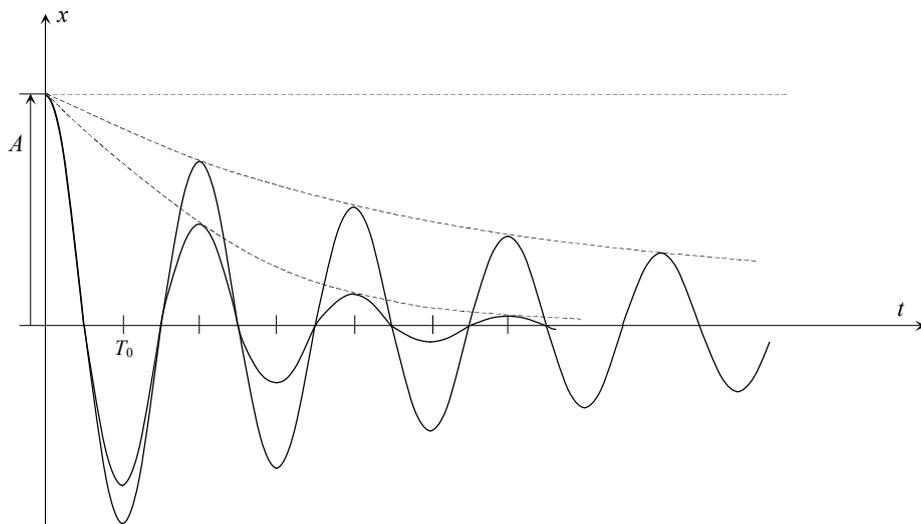
Fig. 2 – Le tre linee tratteggiate hanno tutte equazione  $x = A e^{-(b/2m)t}$ . Il rapporto  $b/m$  ha valore minimo (zero) per quella superiore e valore massimo per quella inferiore. Il periodo  $T_0$  indicato nel grafico è quello di un'oscillazione non smorzata.
