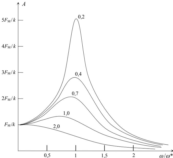
Fig. 4 – Come varia, in funzione del rapporto tra la pulsazione  $\omega$  della forza impressa e la pulsazione  $\omega^* = \sqrt{k/m}$  delle oscillazioni libere, l'ampiezza delle oscillazioni forzate di un oscillatore smorzato. Ogni curva è contrassegnata col valore della grandezza adimensionale  $b/\sqrt{km}$  che misura l'entità dello smorzamento [da Sears - Zemanski - Young].
