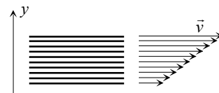
Fig. 12 – Un pacco di «lamine di fluido» in movimento con le rispettive velocità.
